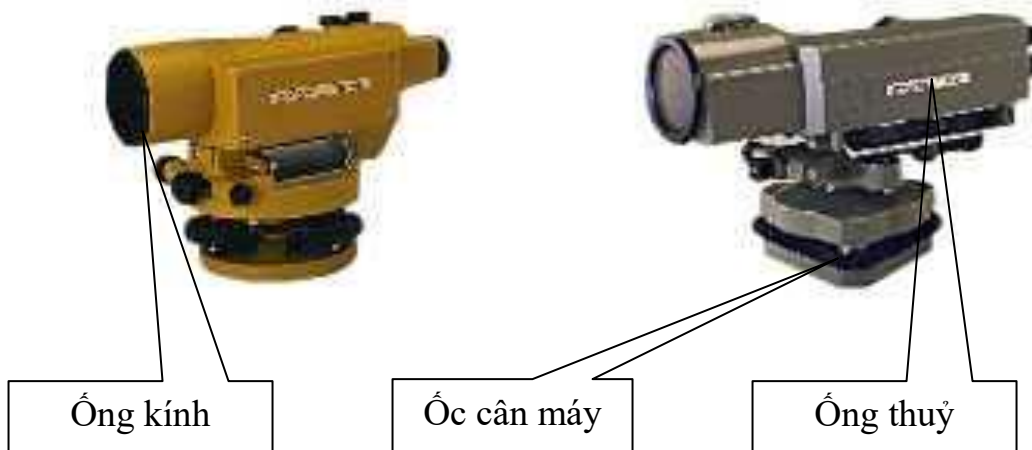
Hình 5.3. Cấu tạo của máy thủy chuẩn Nivo
