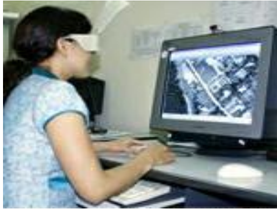
Hình 5.4. Máy scan ảnh hàng không và dụng cụ tăng dày trên trạm ảnh số
