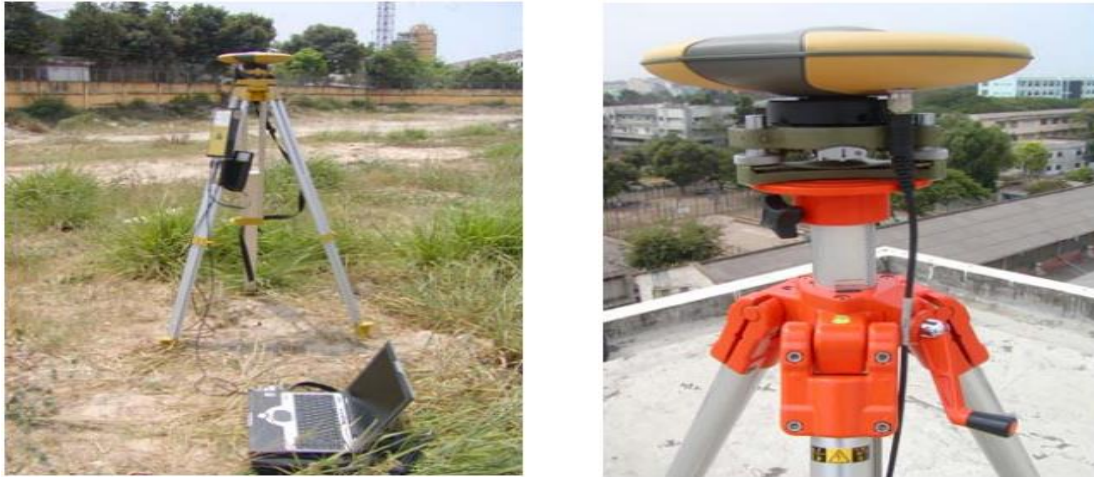
Hình 3.2. Trạm Base và trạm Rover.
